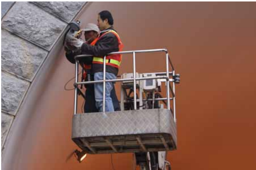
Tunnelmätning med radar i Kina.
