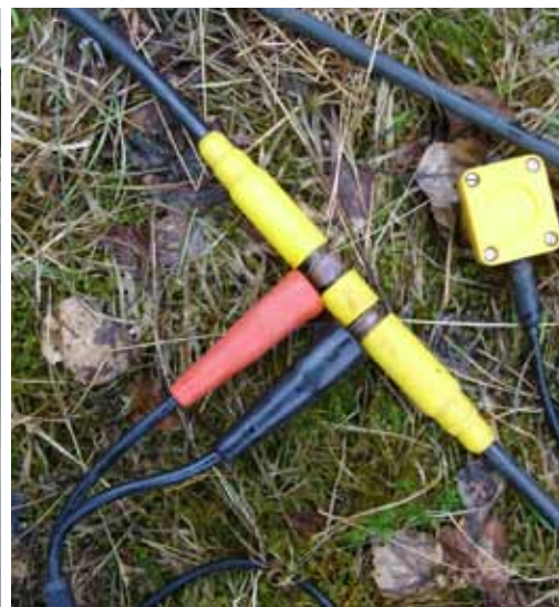
Närbild av en geofon installerad mot mark och kabel för mätning av seismik.
