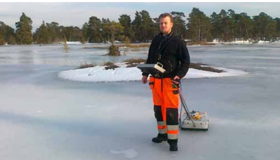
Mätning med markradar på is.
