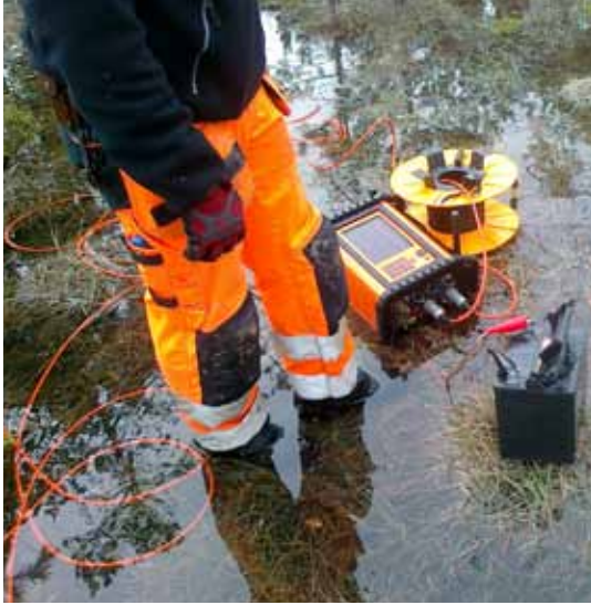
Fältkampanj under blöta förhållanden och pågående resistivitetsmätning.
